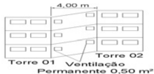
Figura 11 - Aberturas laterais na escada
