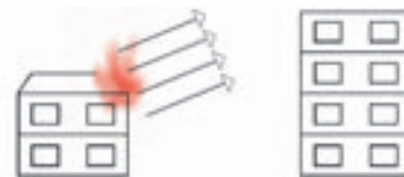
PROPAGAÇÃO ENTRE COBERTURA E FACHADA
