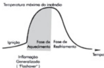
Figura 20 - Curva temperatura - tempo de um incêndio
