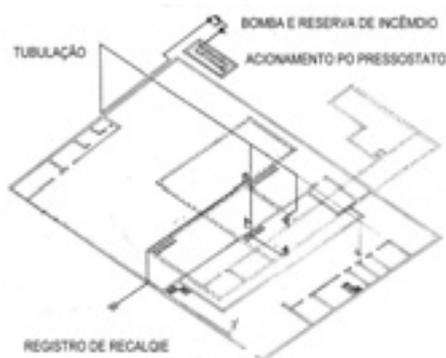
Figura 59 – Isométrica de sistema de hidrantes
